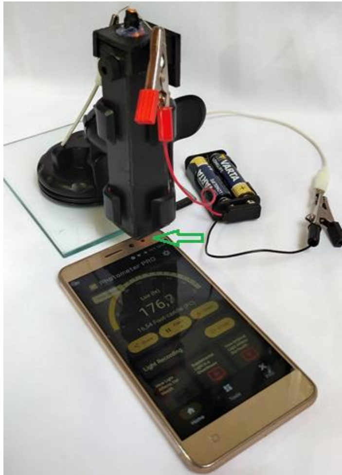
Obrázek č. 4 – Ukázka správného sestavení aparatury pro měření. Všimněte si světlého červeného terčíku (zelená šipka), který je nasměrován (vycentrován) na senzor mobilního telefonu.
